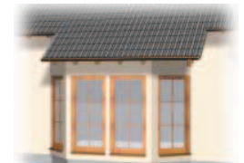
arkýř široký s pultovou střechou
